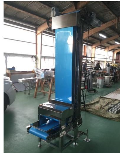
食品工場向け機械は部材は全てがステンレス製・衛生的
